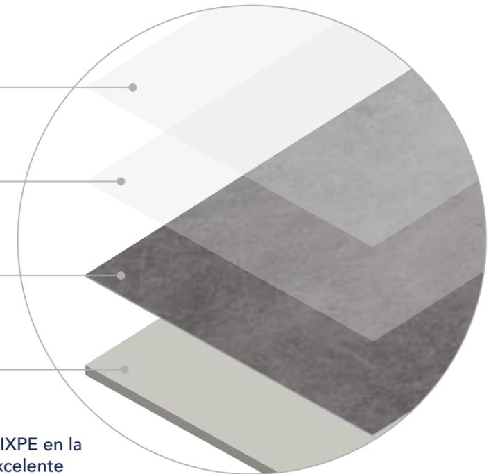
Nuestros suelos Piryta llevan una capa extra de IXPE en la parte inferior del producto para asegurar una excelente instalación, con mayor rapidez, un confort más elevado, aislamiento térmico y aislamiento acústico.
